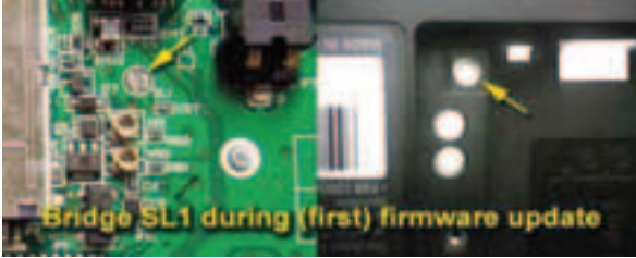
МОСТ SL1, КОТОРЫЙ НЕОБХОДИМО ЗАМКНУТЬ ПРИ УСТАНОВКЕ FLASHME.
